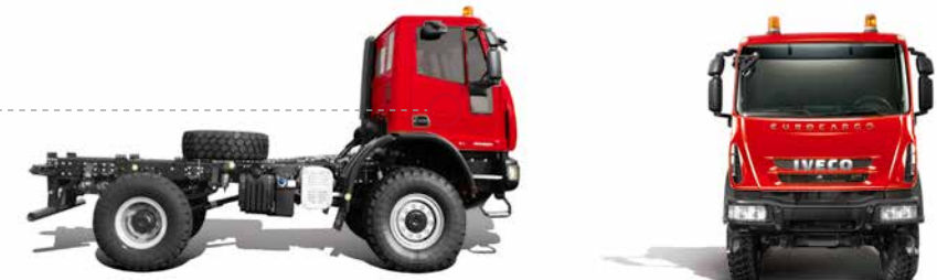
两步踏板驾驶室 适用于11.5-15吨4x4系列卡车
