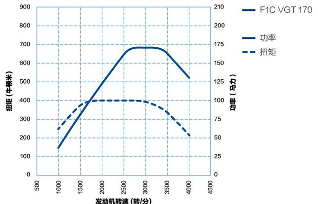
最大扭矩值的发动机转速范围大，发动机低转速时扭矩和功率更高。
