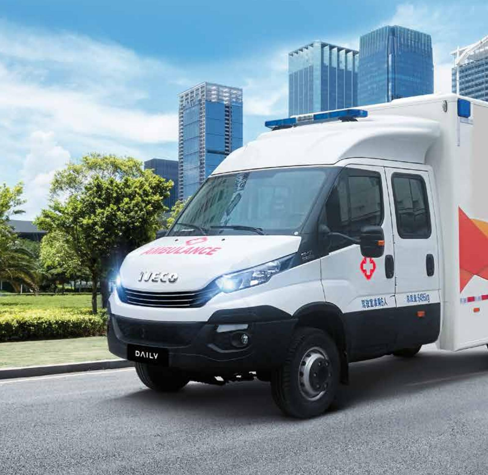
依维柯Daily能够提供范围广泛的医疗救护行业用车底盘，产品型号丰富，车辆总重覆盖广，其中3.55吨及4.5吨是院前救护车的完美平台，整车长度在6米以内。而5吨、6.5吨和7吨是方舱式救护车的理想选择，可以选择多种轴距，最大车长可达8米。依维柯Daily可以配备后空气悬架，最大限度地保证出色的减震性与车辆行驶稳定，在救护路上提供更好的保障。依维柯Daily 4X4可以应对各种路况，克服最极端的路况条件，实施应急救援与医疗救护。
