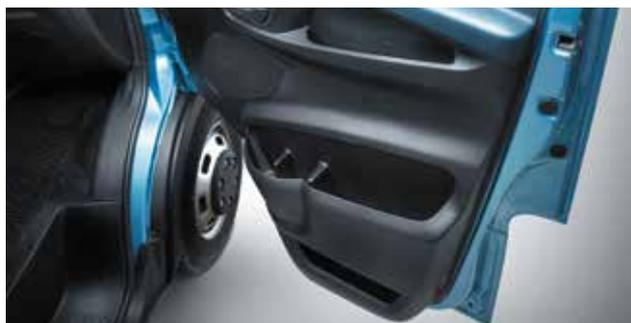
门内板经过重新设计，有一个开放的隔间，您可以在这里存放急救箱。驾驶室提供多达 18 个实用的储物格，您可以将所有的个人和工作材料保存在手边，有条不紊。
