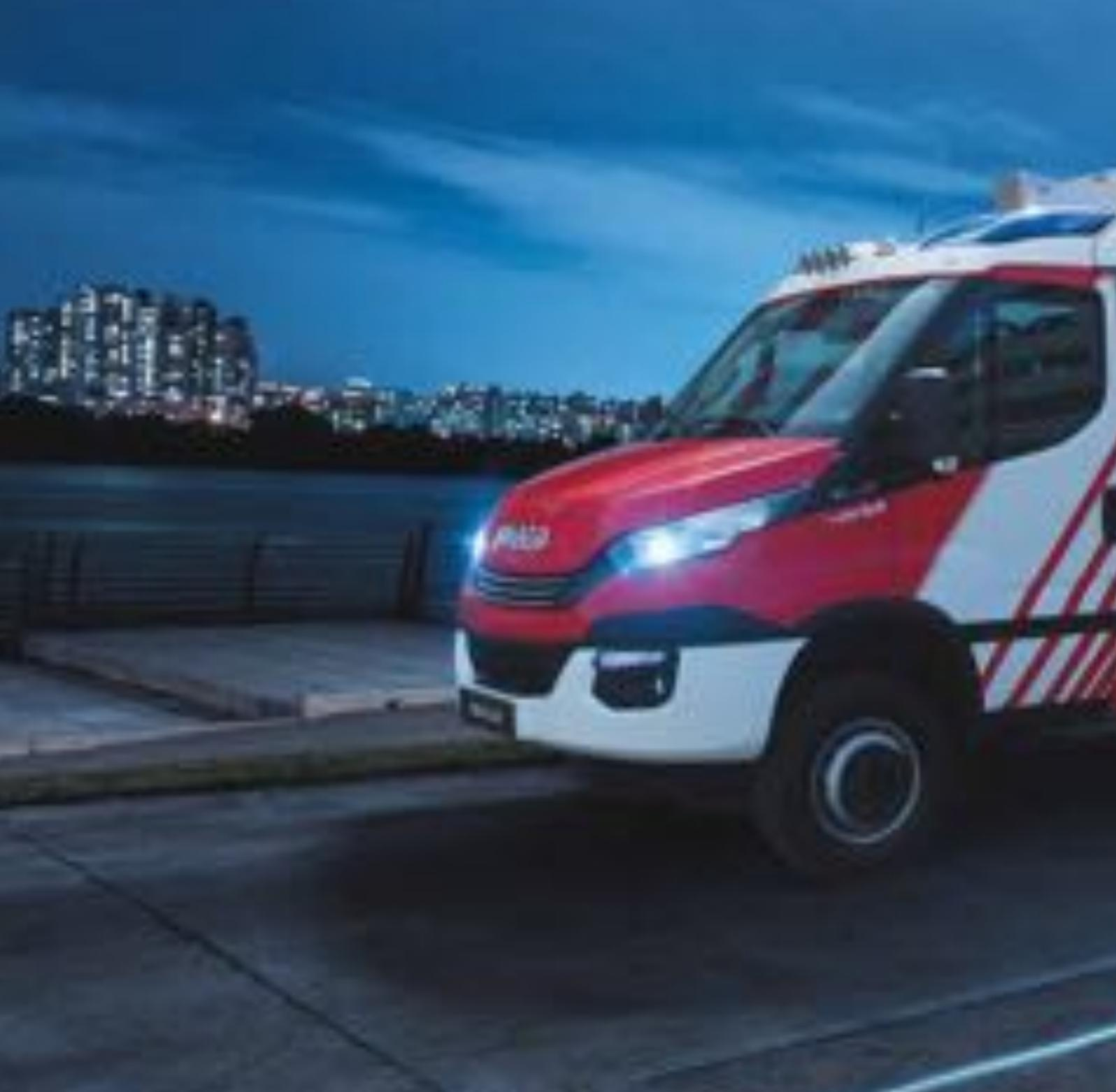
依维柯Daily因其底盘车架结构极为坚固，且车辆总重高达7吨，有效载荷可达4.5吨，方便安装大容量水箱及重型营救设备。搭载F1C 3.0升发动机，功率输出高达170马力，性能卓越。400牛顿米的扭矩允许Daily消防车安装大功率取力器，用更小尺寸的身材满足了同类功能车辆的救援任务，间接提升了整车的通过性能。依维柯Daily可以提供单排和四门双排两款驾驶室，满足客户对小型救援车改装的一切需求。身形灵巧，快速响应是Daily作为消防救援车的绝对强项，可以最快抵达受灾现场，为救援后续大部队争取更多关键时间。Daily 4X4能在各种恶劣路面环境下进行消防救援作业。Daily 4X4配备抛物线形钢板弹簧悬架系统、扭力杆、液压筒式减震器、前后轴差速锁以及中央差速锁等配置，有着十分强大的越野能力，而48度的接近角、39度的离去角也使得它几乎能够通过所有的路况。
