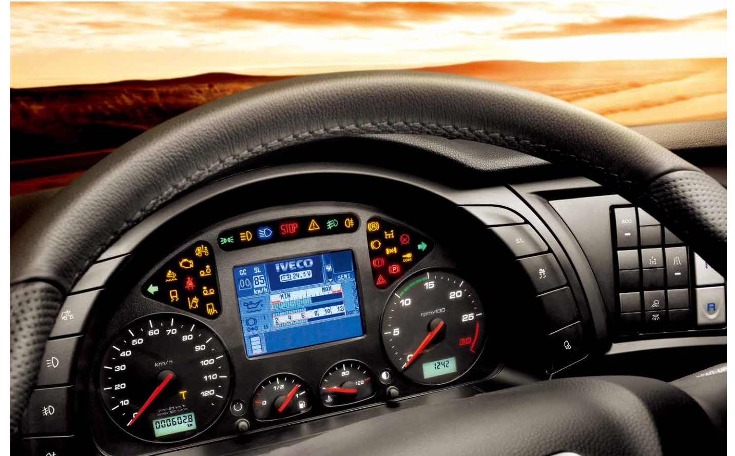
基于车辆的实际负荷， ECOSWITCH 限定了最高车速并优化了行驶性能。
