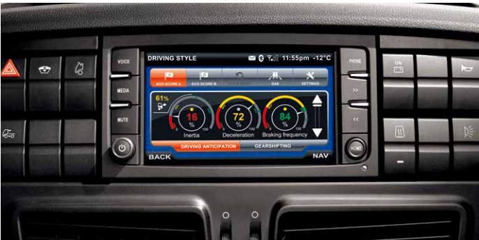
每个指标 通过模拟指示器以百分数的形式在屏幕中央 实时显示 给用户。分数越高，则就燃料节省而言的驾驶技术越好。
