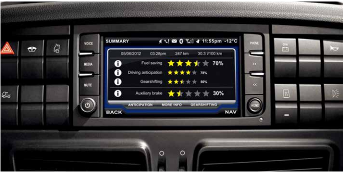
每次旅程结束时，驾驶员可以在监视器上看到以图表形式显示的、百分数表示的 所有性能参数汇总 。
