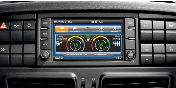
驾驶技能评估： 通过一种评估驾驶员燃料节省技术的先进算法（由依维柯开发），从发动机、车辆和GPS获得数据。根据任务艰巨程度在三层树状结构中，选择一套指标来进行。
