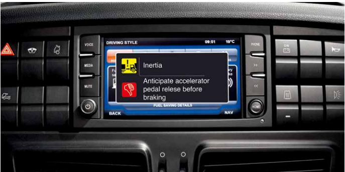
在车辆运行时， 燃料节省建议 会在IVECONNECT的屏幕上出现（换挡、制动、发动机制动、加速和惯性）。
