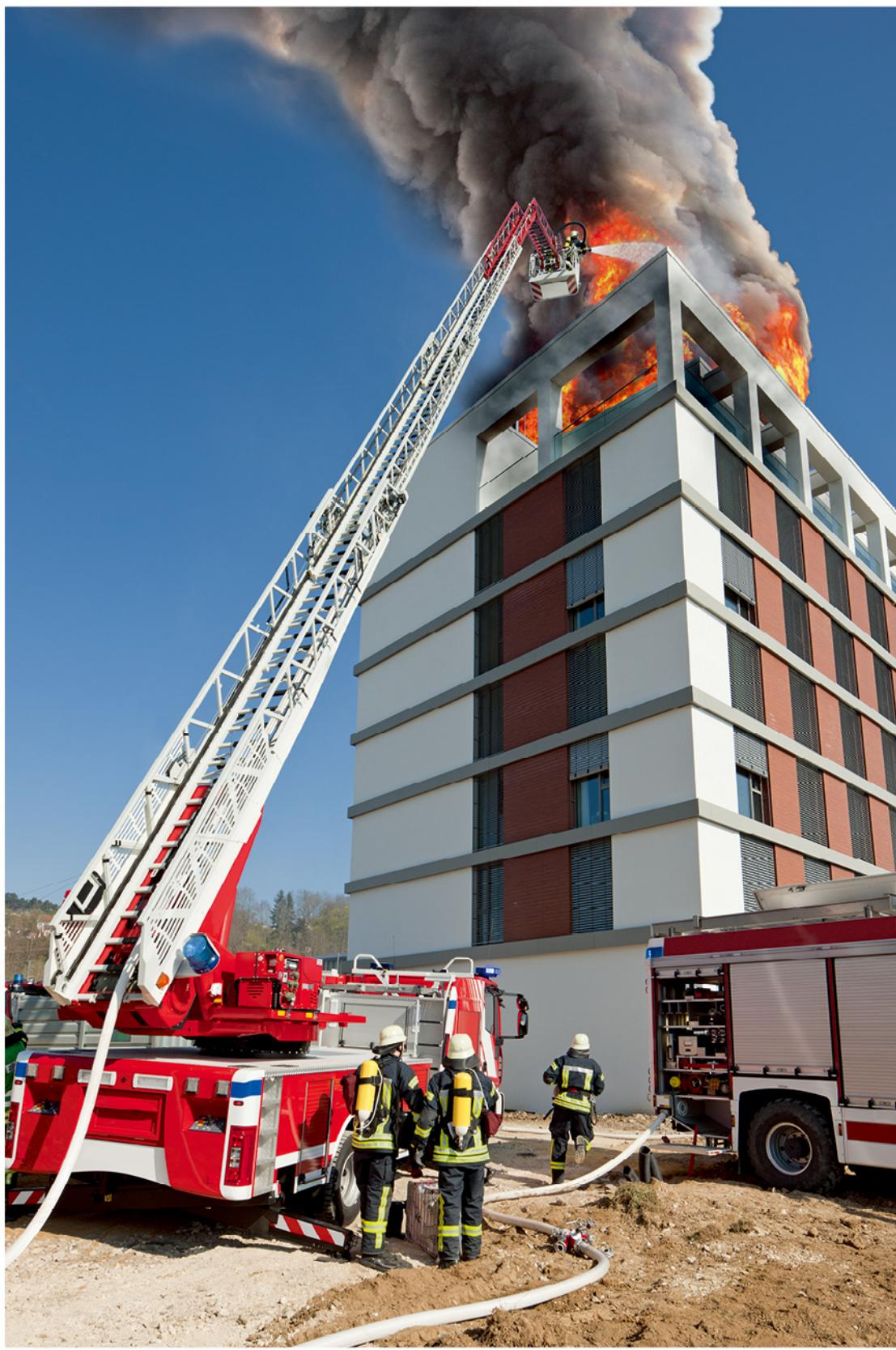
新型直曲臂云梯消防车 32米新型直曲臂云梯消防车，2轴底盘，小巧灵活。第一节云梯可单独操作，并可做弯曲，适用于复杂的火灾救援现场，尤其适用于拥挤的城市救援。
