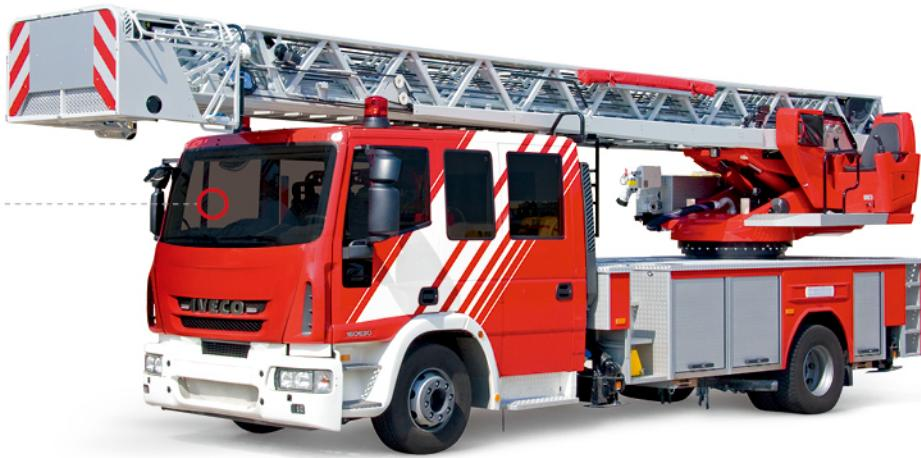
**直臂云梯消防车 27米 -39米**云梯消防车，均采用2轴底盘，小巧灵活，能快速在较窄路面中穿梭，其特有的无级可调“X”型支腿系统，适用于复杂的路况及路面。整车操作便捷、快速，更符合城市高空救援及高空灭火的需要。
