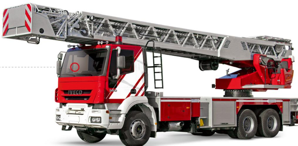
**直臂云梯消防车 55米 /60米**直臂云梯消防车，仅采用3轴底盘，小巧灵活，能快速较灵活的行驶在城市道路间，其特有的无级可调“X”型支腿系统，适用于复杂的路况及路面。整车操作便捷、快速，更符合城市高空救援及高空灭火的需求。
